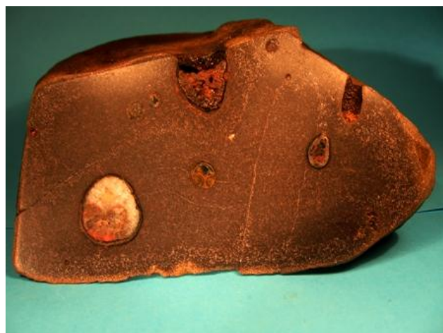
Рис.5 Образец №1, пришлифовка. На фото видно, что материал миндалинов выветривается быстрее, чем материал основной матрицы
